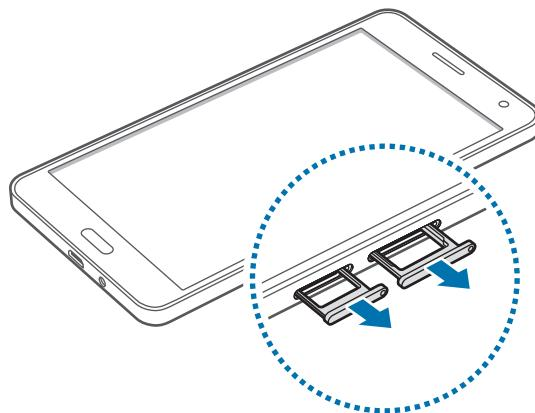
**3 将 UIM 或 SIM 卡的金色触点朝下放入 UIM 或 SIM 卡托盘中。**
