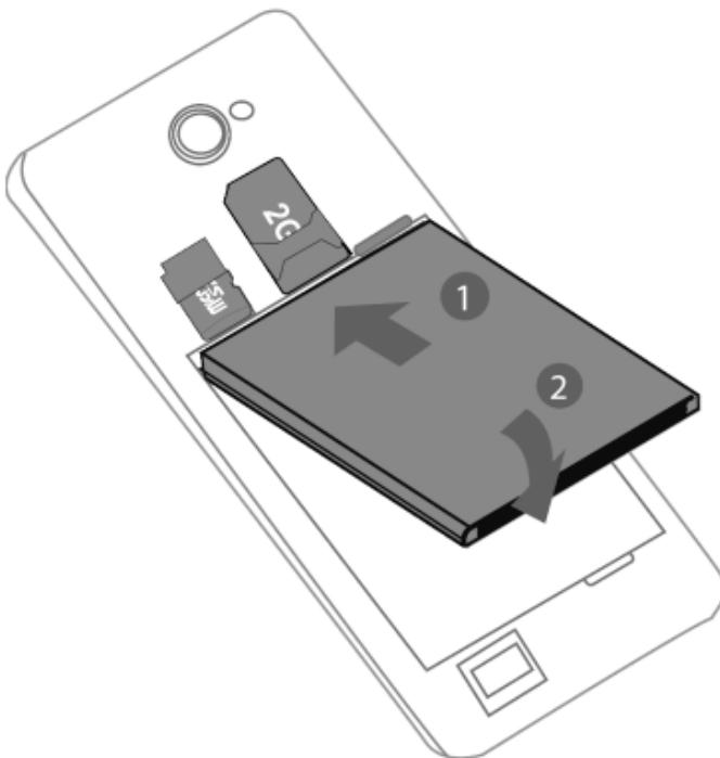
**注意：**拆卸电池之前一定要将手机关机并移去外部电源。绝对禁止在开机的情况下直接取出电池，否则可能损坏 Micro UIM/SIM 卡和手机。
