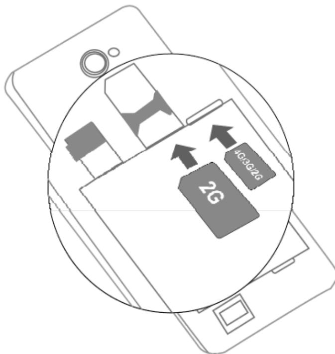
3. 根据下图中箭头方向将存储卡推入卡槽。
