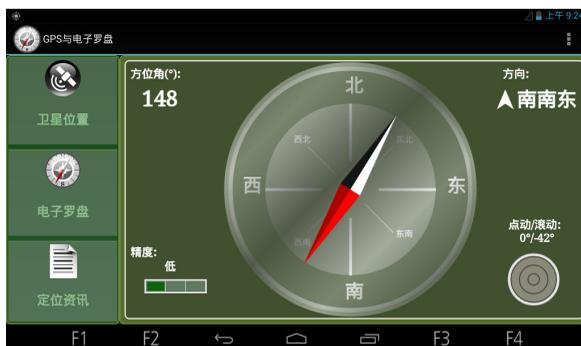
[精度] 信息供您参考。当程序察觉到校准的需要时, 会弹出校准图像要求您校准电子罗盘。请将设备依屏幕图像所示以横的 8 字型挥动, 持续挥动直到图像消失为止。
