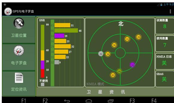
SBAS (satellite-based augmentation system) 可提升 GPS 设备的准确和可靠度。此功能需搭配地面的基站才能实现。在设有 SBAS 基地站的地区, 本设备的 SBAS 功能即可发挥功效。您可以启用此功能。(请见第 7 章的「GETAC 外围设备」。)
