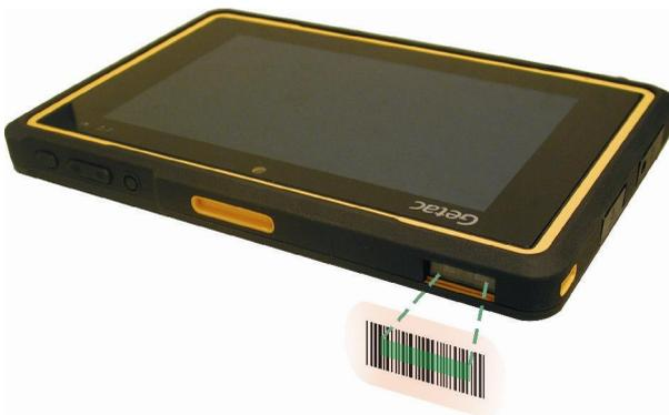
**注：**如果扫描中的条形码会反光（例如纸质为亮面上光膜），可能需要将条形码倾斜+5°以避免反光。
