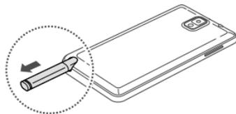
从插槽拔出 S pen 触控笔时，设备将检测触控笔并执行以下操作：
