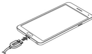
使用 USB 2.0 数据线时，将 USB 数据线按照下图所示插入多功能插口的右侧。
